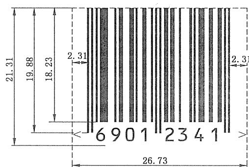
图 13 EAN-8 条码符号尺寸示意图
