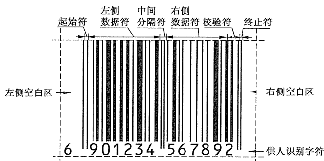
图 1 EAN-13 条码的符号结构
